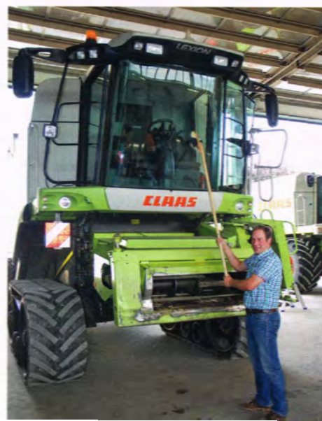
Mit einem Besen, der an einem Teleskoprohr montiert ist, wird das Reinigen von Kabinenscheibe und Spiegel vereinfacht.
